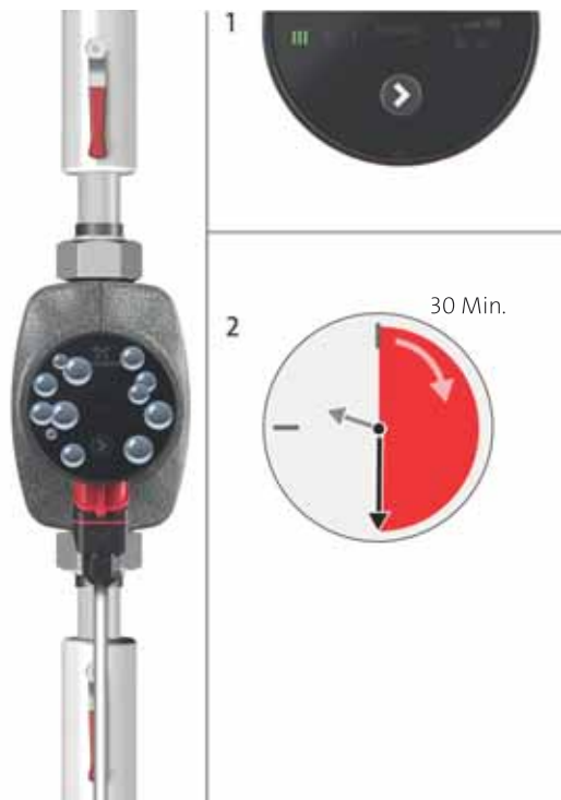
Afb. 8 De pomp ontluichten
